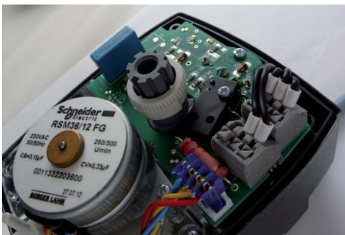
27. Vyjmout kroužek s osazením pro spínání mikrospínače.
