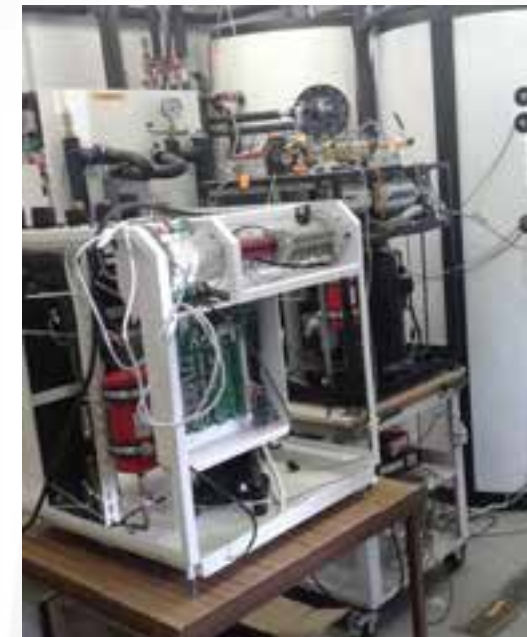
prototyp 2 (1fázový, desup, condenser) řešení vašeho topení testováno v Regulusu, 2015 COP = 4.49 (B0/W35)
