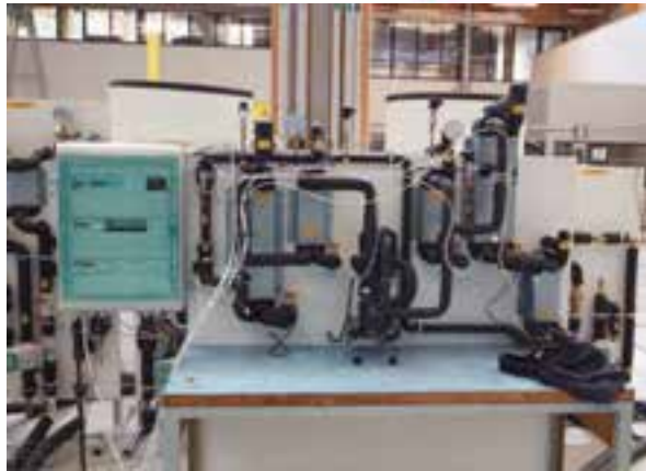
experimentální prototyp (triple sink) testováno na ČVUT COP = 4.3 (B0/W35)
